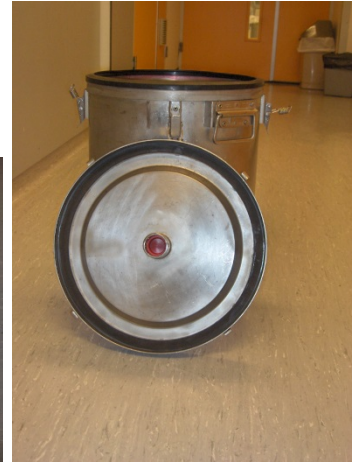
Deksel RVS container onderzijde (siliconenrubberrand en rode plopdop)
