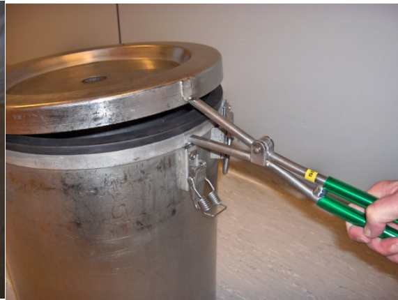
Speciaal gereedschap om RVS container te openen
