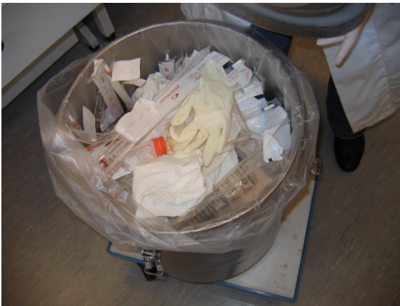
RVS container met krimpzak en niet homogene inhoud
