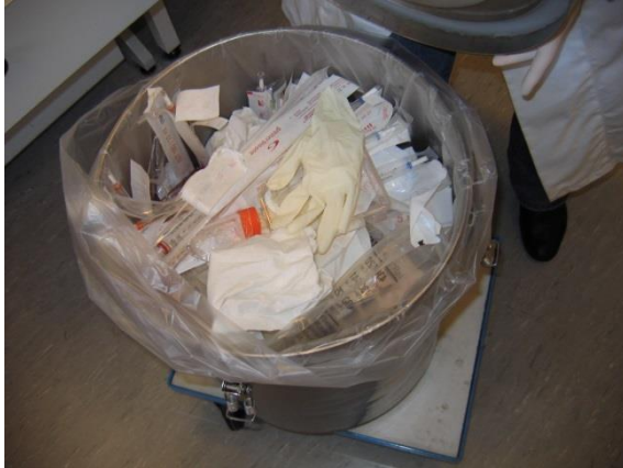
RVS container met krimpzak en niet homogene inhoud
