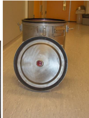
Deksel RVS container onderzijde (siliconenrubberrand en rode plopdp)
