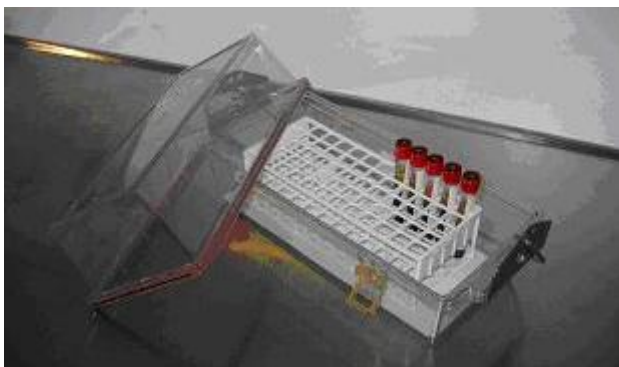
Figuur 1: Een biocarrier met inhoud (buisenrek met buizen).
